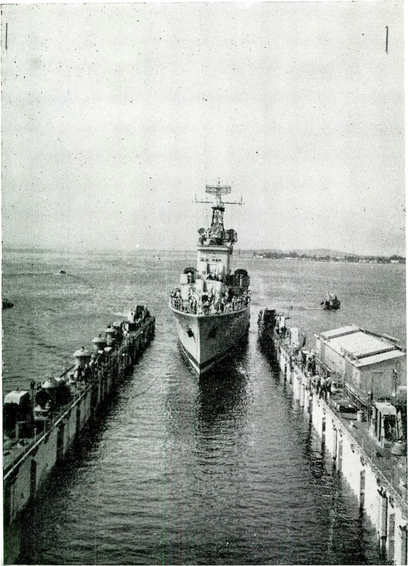
El destructor ARC. 20 de Julio que anteriormente era carenado en el exterior por falta de instalaciones apropiadas en Colombia, entra al Dique Flotante con sus propias máquinas.
