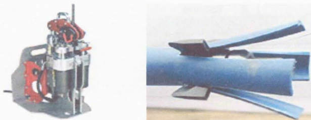
FIGURA NO. 8 EQUIPOS PORTABURSTS 2
