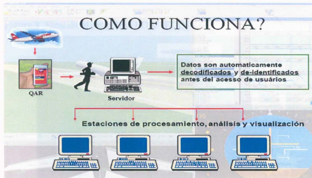
Figura 7 Diagrama de funcionamiento de un programa FDA / FDM O FOQA.
