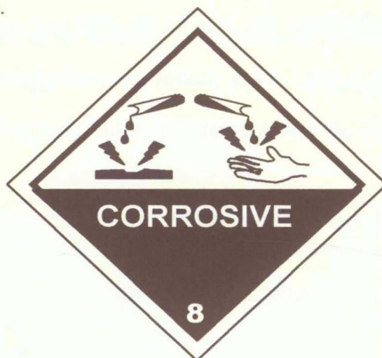
Figura No.21 Sustancia Corrosiva
