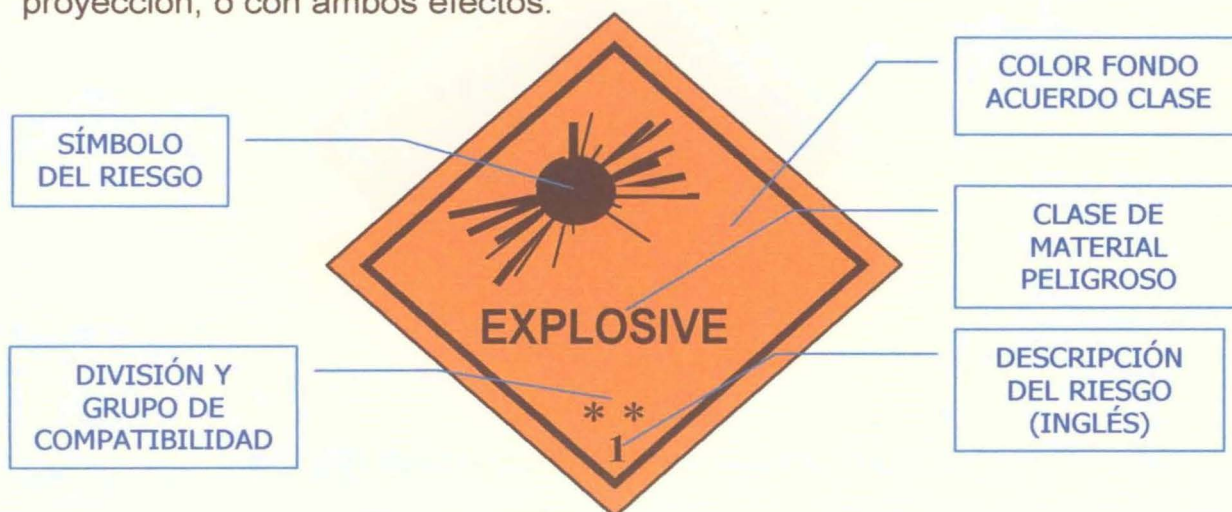
Figura No.2 Etiqueta Explosivos
