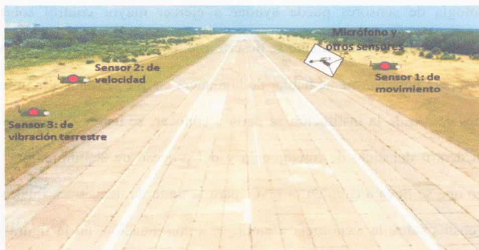
Figura 2 Pista de aterrizaje y ubicación de sensores
