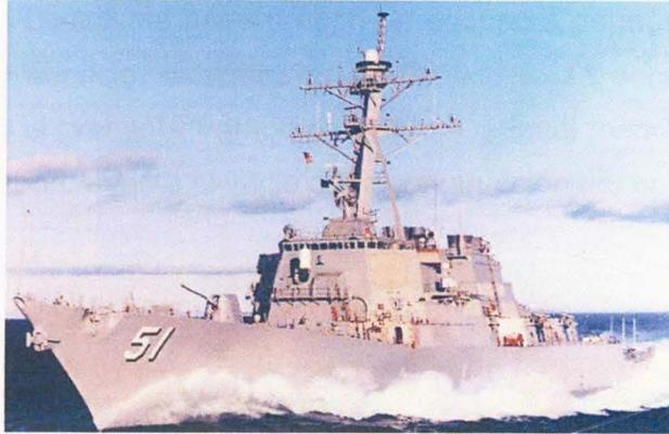
Ilustración 16. Destructor clase *Arleigh Burke*. Se observa uno de los paneles del radar multipropósito SPY-1 por debajo del puente de navegación
