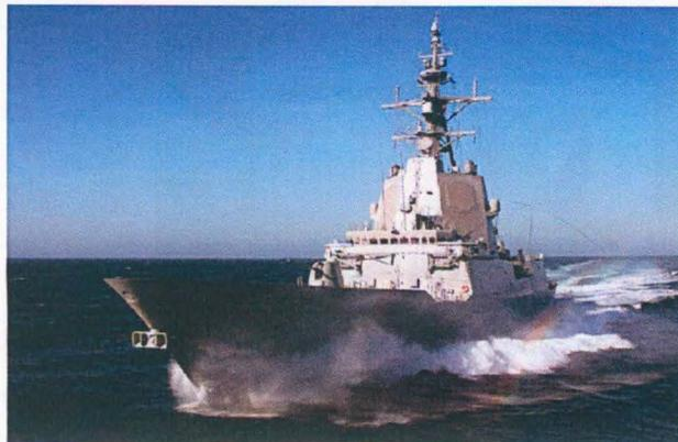
Ilustración 17. Fragata F-100. Se observan dos de los paneles del radar multipropósito SPY-1D por encima del puente de navegación
