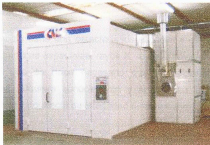
Figura 30. Cabina de pintura con medidas de seguridad
