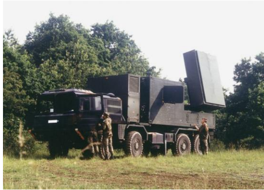
Figura 4. radar de localización de artillería “Cobra”
