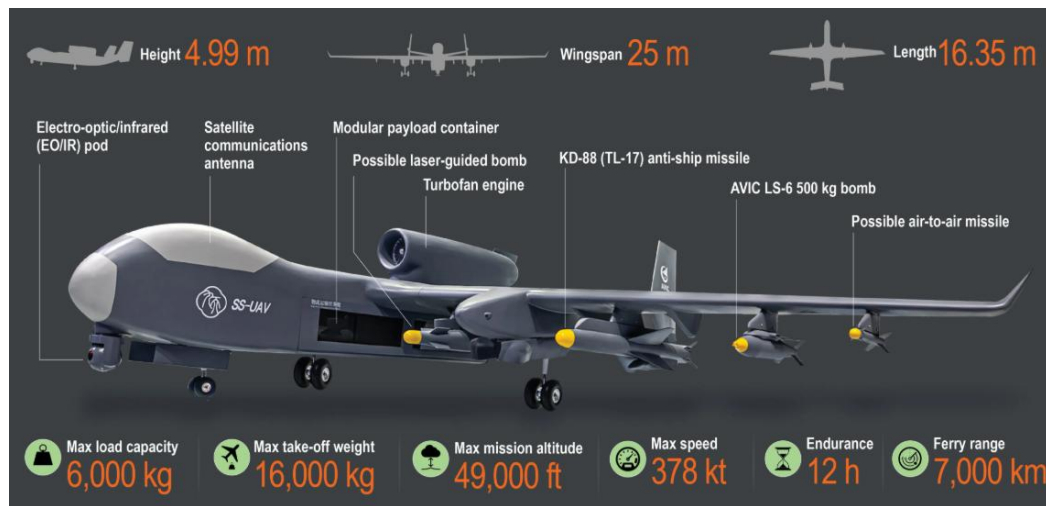
Figura 13. Configuración del vehículo no tripulado para enjambre de drones chino. Fuente: Kadidal, A. (2024). Airshow China 2024: AVIC reveals new modular payload-capable UAV. JANES.
